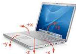
Le SMS vise à protéger le disque dur en cas de choc (chute de l'ordinateur portable par exemple) : plusieurs capteurs mesurent les mouvements dans l'espace du disque dur (en fait des accéléromètres) et parquent les têtes de lecture/écriture du disque en cas de détection de mouvements brusques afin que celles-ci ne risquent pas d'endommager le disque ou ses données.
