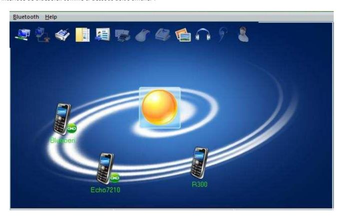
**II-3.** Faire détecter la Wiimote par le logiciel BlueSoleil, en cliquant avec le bouton droit de la souris sur le soleil, et en demandant au logiciel de rechercher les dispositifs Bluetooth. Appuyer aussitôt et simultanément sur les boutons "1" et "2" de la Wiimote.
